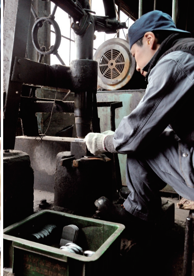
(写真左上) 鉋の刃の裏側に模様をつける彫金を行った後、厚みを揃える野々村工場長。鉋の全工程から彫金、銘切りまでを担当する。(左下) 播州三木打ち刃物の鉋の完成。(右) 鉋の刃の裏側に模様を付ける作業。
