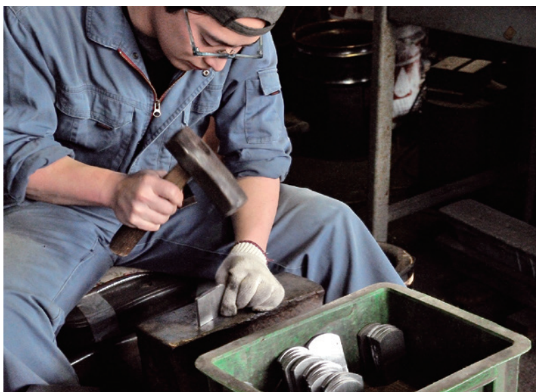
(写真左) 地金を鍛造中の魚住さん。(右上) 地金に使う錨の鋳。(右下) 刻印打ち。鉦の銘や刻印を打つ作業。行っているのは入社4年目の坂本さん。刃の製造と台打ちのできる職人として修業中。
