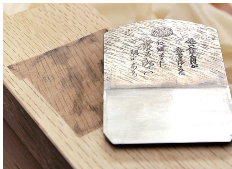
(写真左上) 鉋の刃の裏側に模様をつける彫金を行った後、厚みを揃える野々村工場長。鉋の全工程から彫金、銘切りまでを担当する。(左下) 播州三木打ち刃物の鉋の完成。(右) 鉋の刃の裏側に模様を付ける作業。
