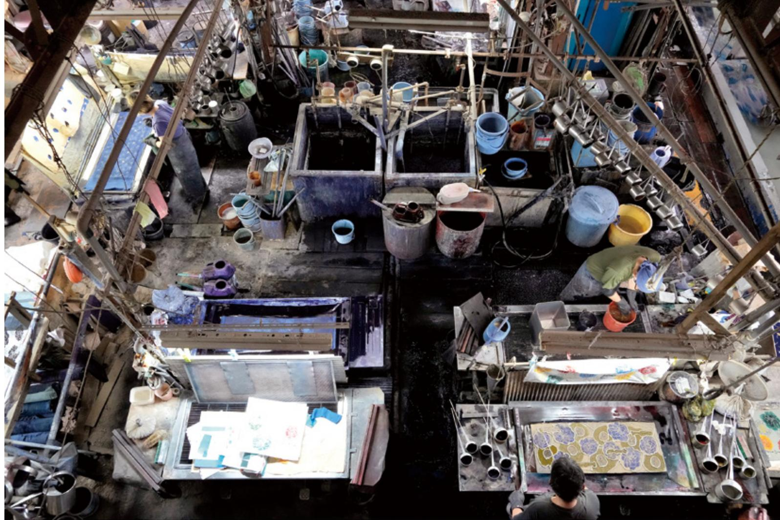
染工所では、まず練地といって染料の浸透をよくするために、薬剤を入れた水槽に生地をつける。それを巻取機で丸巻にして、枠に張った型紙を生地にのせ、へらで防染糊を付ける型置き、染色、水洗い、乾燥と続く。
