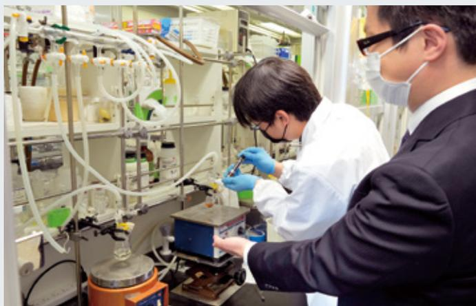
半導体高分子の合成。窒素気流下で原料（モノマー）に遷移金属触媒を加えて制御しながら重合している。
